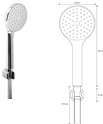
**DIANA S100-Neu Eco Wannen-Brauseset 1-strahlig** rund, bestehend aus: Klassik-Wandbrausehalter starr, verchromt mit doppelter Befestigung. ECO-Handbrause, Anschluss DN 15 (1/2"), Brausekopf Ø 110 mm, mit einer Strahlart inkl. ECO-Paket zur Durchflussbegrenzung auf 6 l/min bei 3 bar, Isoflex-Brauseschlauch, 1250 mm, verchromt, (DI451411500) **65,50 €**
