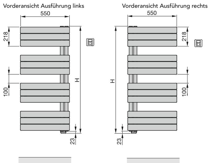
H = Bauhöhe K = Konsole(n) V = Vorlauf 1/2" R = Rücklauf 1/2" \* = Entlüftung 1/2" Maße in mm
