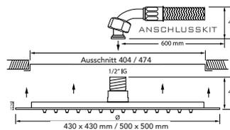
**DIANA L400 Regenpaneel eckig, ohne Licht** zum Deckeneinbau, Edelstahl verchromt, Silikonknochen mit Antikalkausstattung, Anschluss 1x 1/2 Zoll, Lieferung inkl. Einbaurahmen und Anschlusskit, Deckenabhangung 100 mm, 430 x 430 mm, Durchfluss 23 l/Min\*, (DI456214500) 1.069,- €
