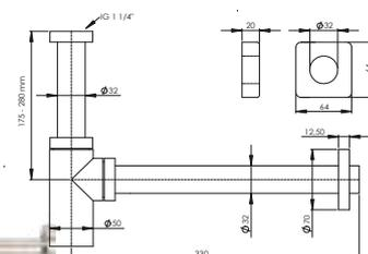
**DIANA-Neu Design-Flaschensiphon Tauchrohr 250 mm, Abgangsrohr 300 mm, Rosette D=70 mm, zusätzl. quadrat. Rosette, 64x64 mm, 1 1/4\"/>**
