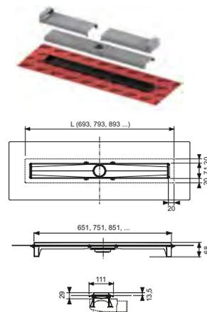
Die Länge des Rinnenkörpers ist abgestimmt auf die Baumaße der 2 DIANA Design-Roste und der verfließbaren Mulde // Länge L für Rinnen von 693 bis 1193 mm (Sichtmaß nach Einbau L-42 mm) // Jeweils für Raumaufstellung oder für Wandausführung // Montagefüße müssen separat mitbestellt werden.
