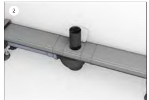
Die geschlossene Rinne wird im Raum platziert und ausgerichtet. Mit den optional erhältlichen Montagefüßen lässt sich das einfach bewerkstelligen. Das Abflussrohr kann platzsparend unter der Rinne verlegt werden.
