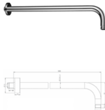
DIANA O100-Neu Wandarm (1/2"), 45° abgewinkelt, für Kopfbrausen 1/2", Ø 20 mm, aus Metall, mit Rosette, verchromt, Ausladung 300 mm, (DI452824500) Ausladung 190 mm, (DI452823500)
