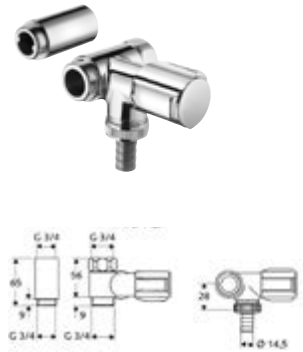
DIANA Nebenanschlußventil für Wandbatterie rechts mit Rückflussverhinderer und Schlauchverschraubung, Prüfzeichen PA-IX 2851/II, Dimension DN 20 G 3/4 AG x G 3/4 IG, verchromt, (DI407923500)
