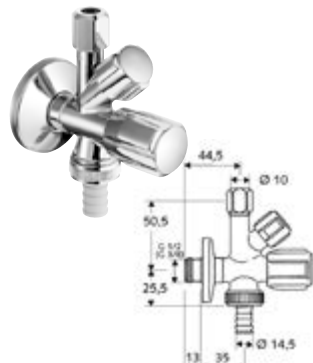
DIANA Kombi-Eckventil 1/2" mit ASAG mit selbstdichtendem Anschlussgewinde, mit Rückflussverhinderer und Schlauchverschraubung, Prüfzeichen PA-IX 2850/IA, Dimension DN 15 G 1/2 AG, verchromt, (DI407901500)
