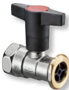
**Innengewinde, Messing vernickelt, Öffnungsdruck maximal 20 mbar, maximaler Betriebsdruck: PN 10, maximale Betriebstemperatur 120°C, Einbau vor der Pumpe**
