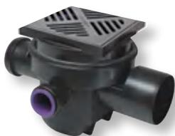
mit herausnehmbarem Rückstaudoppelverschluss und handverriegelbarem Notverschluss, Geruchsverschlusshöhe 60 mm, mit Schlammeimer, Abflussleistung 1,8 l/s, zwei Zulaufe DN 50 und einen Zulauf DN 70 mit Blindstopfen. Aufsatzstück aus Kunststoff, teleskopisch höhenverstellbar von 25 mm–65 mm. Norm: DIN EN 13564 Typ 5. Auslauf: 2,5 Grad (seitlich). Aufsatzstück/Schlitzrost: Kunststoff schwarz. Rostgröße: 200 x 200 mm. Belastungsklasse: K3 (300 kg).
