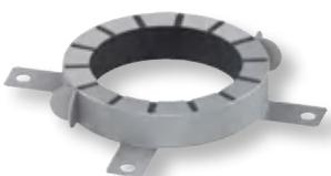
Brandschutzmanschette zur Montage unterhalb der Decke, bei Verwendung der senkrechten Bodenabläufe DN 70 und DN 100 in Verbindung mit einem PP-HT Abwasserrohr nach EN 1451. Zur hochfeuerbeständigen Abschottung der Deckendurchführung in Massivdecken bis 120 Minuten.
