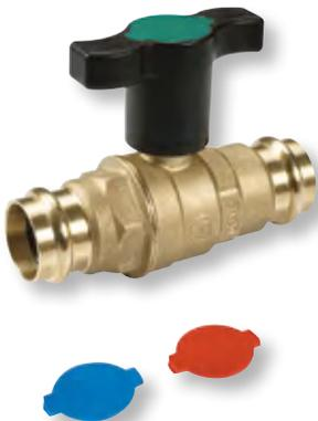
Messing, DIN-DVGW geprüft, zertifiziert in Verbindung mit CU-Rohr: Reg.-Nr. 6102BTO545 mit vollem Durchgang, zur Verbindung von Kupfer-, Edelstahl- bzw. C-Stahlrohren und Kugelhahn ohne zusätzlichen Übergang, auswechselbare farbige Kappen (grün, rot, blau) oberhalb des T-Griffs zur Kennzeichnung für die jeweilige Betriebsart, max. Betriebstemperatur: +5°C – 110°C, max. Betriebsdruck: PN 35, bzw. PN 28
