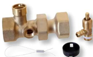
zum Prüfen von Membranausdehnungsgefäßen ohne Entleerung der Anlage und Demontage des Gefäßes, aus Messing MS 58, mit Entleerungshahn und Plombiersatz, Nenndruck PN 10, maximale Betriebstemperatur 110 °C, alle Anschlüsse flachdichtend.
