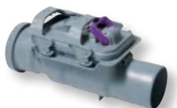
**für fäkalienfreies Abwasser.** Zwei Klappen selbsttätig schließend, eine davon als handverriegelbarer Notverschluss. Zu-/ Ablauf zum Anschluss für HT-Rohr nach DIN 19560. Norm: DIN EN 13564 Typ 2. Einbaukörper: Kunststoff grau. Einbauart: freiliegende Abwasserleitung. Waagrecht.
