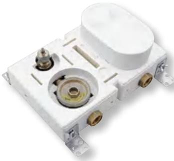
vorgefertigter Unterputz-Montageblock aus FCKW-freiem Styropor inklusive Vormontageeinbausatz für Wasserzähler-Trockenkapsel, nur eine Verbindungsstelle zwischen Vormontagegehäuse und AZK-Ventil (Dichtung mit O-Ring), Blindflansch als Spüldeckel, mit Spindelventil, Styropor-Einputzhaube, verzinkte Montagewinkel, HBCD-frei, geeignet für Einbau in Leichtbauwänden, Schnittstelle DM1
