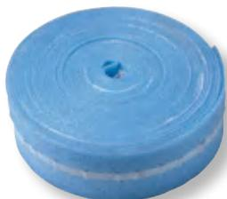
Für Zement- und Fließestriche und alle Systemplatten aus geschlossenzelligem Polyethylenschaum, mit seitlich angeschweißter extrabreiter Folienschürze und vorbereiteter Abreißschlitzung, nach DIN 18560, selbstklebend.
