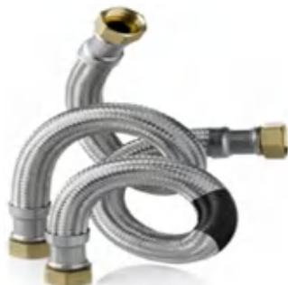
Flexible Panzerschläuche (HDPE High Density Polyethylene Inliner), DVGW Trinkwasserzulassung, W270 und KTW-A, extrem flexibel und knickfest für engste Einbausituationen geeignet, konstante Flussrate, flexibler korrigierter PERT Innenschlauch, Innen- und Außengewinde aus Messing, rostfreie Edelstahlumflechtung AISI 304, Betriebsdruck 10 bar, Temperatur geprüft 90 °C, inklusive Faserdichtung
