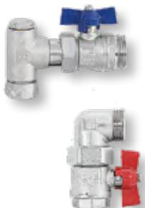
ohne Wärmezählervorbereitung passend für DITECH Verteileranschlussstationen L und S, mit Winkelanschlussstück 90° aus Edelstahl und Vor- und Rücklaufkugelhahn aus Messing vernickelt, Flügelgriff für Vorlauf in rot und Rücklauf in blau, Primäranschluss 3/4" oder 1" Innengewinde vertikal
