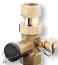
Kappenventil aus Messing zum Absperrn und Entleeren sowie zur Kontrolle, Wartung und eventuellem Austausch von Membran-Ausdehnungsgefäßen. Gegen unbeabsichtigtes Schließen mit Draht und Plombe gesichert. wird entsprechend DIN EN 12828 in die Ausdehnungsleitung vor dem Ausdehnungsgefäß eingebaut. Technische Daten: Nenndruck: PN 10. max. Betriebstemperatur: 130 °C.
