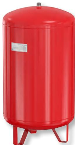
für geschlossene Heizungs- und Kühlanlagen gemäß EN12828, Zulassung gemäß EU Druckgeräterichtlinie 2014/18/EU, Stickstofffüllung für längeres Aufrechterhalten des Vordrucks, Membrane: Stülp-Membrane, geeignet für Zugabe von bis zu 50 % Frostschutzmittel (Glykolbasis), Gefäße konform EN13831, geeignet für Anlagen mit max. Durchflusstemperatur von 120°C, maximale Betriebstemperatur (an der Membran): 70°C
