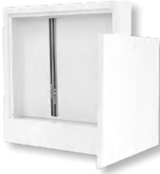
komplett galvanisch verzinkt und beschichtet in weiß RAL 9016, mit höhenverstellbaren Schrankfüßen (130 mm), Stecktür mit Kunststoffdrehriegel, Aufnahme der Verteiler über variable C-Befestigungsschienen.
