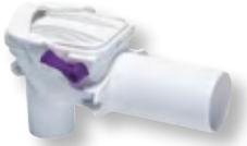
mit zwei selbsttätig schließenden Klappen, eine davon als handverriegelbarer Notverschluss, mit Wandbefestigung. Zulaufanschluss DN 40 senkrecht für bauseitigen Röhrengeruchverschluss, Ablauf DN 50 waagrecht zum Anschluss an HT-Rohr nach DIN 19560. Norm: DIN EN 13564 Typ 5. Einbaukörper: Kunststoff weiß.
