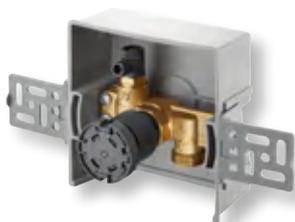
mit vormontiertem Ventil und Thermostat, zur Begrenzung der Rücklauftemperatur, Bautiefe: 60 mm, Wandeinbaukasten mit Thermostatventil, integrierter Rücklauftemperaturbegrenzer, Entlüftungs- und Spülventil, max. Betriebsdruck ps: 10 bar (PN 10), Ventil mit G 3/4" Rohrleitungsanschluss nach DIN EN 16313 (Eurokonus) für DITECH Klemmringverschraubungen
