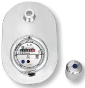
mit patentiertem „Hosenträger“-Dichtungssystem für zuverlässige Bypasskontrolle, mit selbstreinigender Messkammer und unbenetztem Gewinde, Chromgarnitur bestehend aus: einteiliger Rosette mit Zylinder, plombierbar, Ventilgriff chrom, Mediumtemperatur: 30 °C kalt / 90 °C warm, Dauerdurchfluss Q3: 2,50 m<sup>3</sup>/h, metrologische Klasse: R 40 / R 40, Zähleranschlussgewinde: M60 x 2, Betriebsdruck: 10 bar, Einbau: horizontal / vertikal, Schnittstelle DM1
