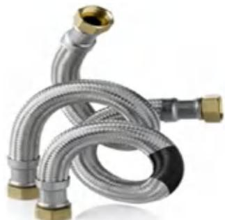
Flexible Panzerschläuche (HDPE High Density Polyethylene Inliner), DVGW Trinkwasserzulassung, W270 und KTW-A, extrem flexibel und knickfest für engste Einbausituationen geeignet, konstante Flussrate, flexibler korrigierter PERT Innenschlauch, Innen- und Außengewinde aus Messing, rostfreie Edelstahlumflechtung AISI 304, Betriebsdruck 10 bar, Temperatur geprüft 90 °C, inklusive Faserdichtung
