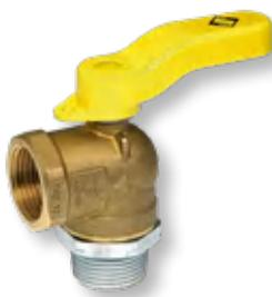
nach DIN EN 331, mit TAE (Thermisch Auslösende Absperrrichtung), DIN 3586, HTB-Ausführung 650 °C/30 min, Gehäuse Stahl verzinkt, Druckfeder Edelstahl, Auslösetemperatur 95 °C ± 5 °C, Umgebungstemperatur max. 60 °C, eingangs Außengewinde, ausgangs Innengewinde, gesicherter Betätigungsgriff aus Aludruckguss, gelb lackiert, Gehäuse Pressmessing, Vollkugel Messing-verchromt, Kugeldichtung NBR, Schaltwellendichtung aus NBR, Betriebsdruck MOP5/C1, DIN-DVGW zertifiziert
