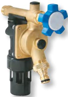
als Ersatz für Zapfventile, Systemtrenner BA zum Schutz des Trinkwassers vor Nichttrinkwasser nach DIN EN 1717 bis einschließlich Flüssigkeitskategorie 4\*, Einbau vor Apparate als Entnahmestelle, Einbaulage beliebig wenn Ablauftrichter unten
