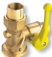
nach DIN EN 331/DIN 3376-2, HTB-Ausführung 650 °C/30 min, eingangs Außengewinde, ausgangs Verschraubung mit Innengewinde, gesicherter Betätigungsgriff aus Aludruckguss, gelb lackiert, Gehäuse Pressmessing Vollkugel Messing verchromt, Kugeldichtung NBR, Schaltwellendichtung aus NBR, Betriebsdruck MOP5/C1, Umgebungstemperatur max. 60 °C, DIN-DVGW zertifiziert
