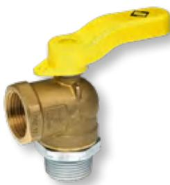
nach DIN EN 331, HTB-Ausführung 650 °C/30 min, mit integriertem Gasströmungswächter Typ K, nach DVGW-VP 305-1, Betriebsdruckbereich: 15 mbar – 100 mbar, eingangs Außengewinde, ausgangs Innengewinde, gesicherter Betätigungsgriff aus Aludruckguss, gelb lackiert, Gehäuse Pressmessing, Vollkugel Messing-verchromt, Kugeldichtung NBR, Schaltwellendichtung aus NBR, Umgebungstemperatur max. 60 °C, HTB 1 bar, DIN-DVGW zertifiziert
