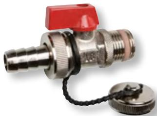
aus Pressmessing MS 58, voller Durchgang, PN 16, roter Griff, mit Schlauchverschraubung, Anschluss 1/2" DN 15, maximale Betriebstemperatur 110 °C
