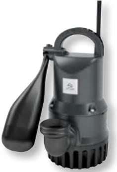
Pumpe mit Hebelschwimmer-Schaltung, automatische Spüleinrichtung, Edelstahl-Motorwelle mit keramikbeschichteter Dichtfläche, automatische Entlüftung mit zusätzlicher Lüftungsschraube, abnehmbares Saugsieb zur flachen Absaugung von Restwasser. Rückschlagklappe, Schwimmer-Arretierung und Rohrbogen 90° IG/IG, sowie 10 m Anschlusskabel im Lieferumfang.
