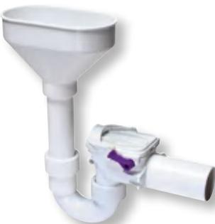
mit zwei selbsttätig schließenden Klappen, eine davon als handverriegelbarer Notverschluss. Mit Wandbefestigung. Röhrengeruchverschluss und Einlauftrichter für Tropfwateranschluss. Ablauf waagrecht zum Anschluss an HT-Rohr nach DIN 19560. Norm: DIN EN 13564 Typ 5. Ablaufgarnitur: Kunststoff weiß. Einbauart: für Tropfwater.
