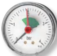
Druckmessgerät für geschlossene Heizungsanlagen, 0–4 bar, mit verstellbarem roten Markenzeiger mit grünem Sektor, rote Marke bei 2,5 bar und grünem Betriebssektor von 1,5–2,5 bar, Genauigkeitsklasse 2,5
