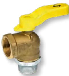
nach DIN EN 331 HTB-Ausführung 650 °C/30 min, eingangs Außengewinde, ausgangs Innengewinde, gesicherter Betätigungsgriff aus Aludruckguss, gelb lackiert, Gehäuse Pressmessing, Vollkugel Messing-verchromt, Kugeldichtung NBR, Schaltwellendichtung aus NBR, Betriebsdruck MOP 5/C1, HTB 1 bar, Umgebungstemperatur max. 60 °C, DIN-DVGW zertifiziert
