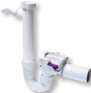
mit zwei selbsttätig schließenden Klappen, eine davon als handverriegelbarer Notverschluss. Mit Wandbefestigung. Röhrengeruchverschluss für Wasch-/Spültische und Schlauchanschluss. Ablauf waagrecht zum Anschluss an HT-Rohr nach DIN 19560. Norm: DIN EN 13564 Typ 5. Ablaufgarnitur: Kunststoff weiß. Nennweite Zulauf: 1 1/4" und 1 1/2" IG.
