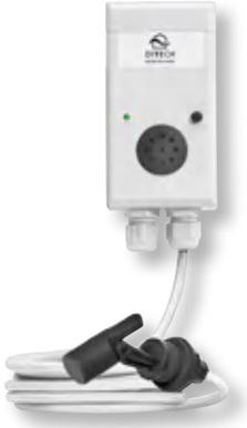
Wasserstandsabhängiger Alarmgeber durch Behälterschwimmerschalter. Kunststoffgehäuse IP20, Netzabhängiger Alarm mit eingebautem Signalgeber, Netzunabhängiger Alarmschluss mit Ladegerät für Akku 9V zum Nachrüsten, Netzstecker 230V/1Ph, potentialfreier Meldekontakt
