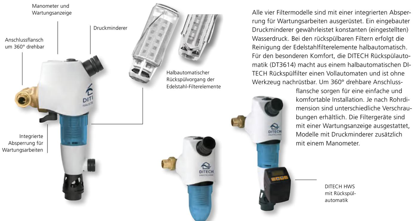
Alle vier Filtermodelle sind mit einer integrierten Absperrung für Wartungsarbeiten ausgerüstet. Ein eingebauter Druckminderer gewährleistet konstanten (eingestellten) Wasserdruck. Bei den rückspülbaren Filtern erfolgt die Reinigung der Edelstahlfilterelemente halbautomatisch. Für den besonderen Komfort, die DITECH Rückspülautomatik (DT3614) macht aus einem halbautomatischen DITECH Rückspülfilter einen Vollautomaten und ist ohne Werkzeug nachrüstbar. Um 360° drehbare Anschluss-
