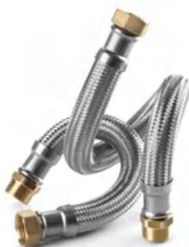
Flexible Panzerschläuche (HDPE High Density Polyethylene Inliner), DVGW Trinkwasserzulassung, W270 und KTW-A, extrem flexibel und knickfest für engste Einbausituationen geeignet, konstante Flussrate, flexibler korrigierter PERT Innenschlauch, Innen- und Außengewinde aus Messing, rostfreie Edelstahlumflechtung AISI 304, Betriebsdruck 10 bar, Temperatur geprüft 90 °C, inklusive Faserdichtung
