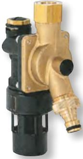
zur Montage an Auslaufventilen, Systemtrenner BA zum Schutz des Trinkwassers vor Nichttrinkwasser nach DIN EN 1717 bis einschließlich Flüssigkeitskategorie 4\*, Einbau vor Apparate als Entnahmestelle, Einbaulage beliebig wenn Ablauftrichter unten
