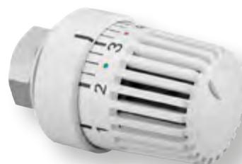
**Gut zu Wissen:** Von einer zur nächsten Zahl auf dem Thermostat erhöht sich die Temperatur um ca. vier Grad. Bei der Ziffer eins erreicht die Raumtemperatur rund 12 Grad, bei Ziffer fünf etwa 28 Grad. Die drei Striche zwischen den Ziffern sind Abstufungen. Ein Strich entspricht einem Grad Celsius.
