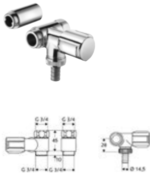
DIANA Nebenanschlußventil für Wandbatterie links mit Rückflussverhinderer, und Schlauchverschraubung, Prüfzeichen PA-IX 2851/II Dimension DN 20 G 3/4 AG x G 3/4 IG, verchromt, (DI407924500)
