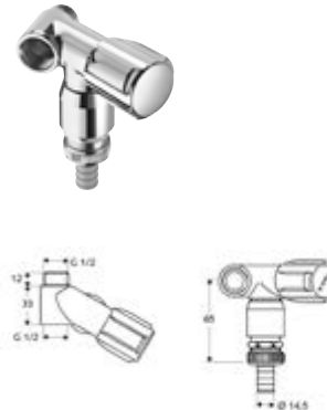
DIANA Nebenanschlußventil mit RV, RB ohne ASAG 1/2" mit Rückflussverhinderer, Rohrbelüfter und Schlauchverschraubung, Prüfzeichen: DVGW zertifiziert, Dimension: DN 15 G 1/2 AG x G 1/2 IG, verchromt, (DI407921500)
