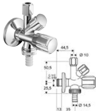
DIANA Kombi-Eckventil 1/2" mit ASAG mit selbstdichtendem Anschlussgewinde, mit Rückflussverhinderer und Schlauchverschraubung, Prüfzeichen PA-IX 2850/IA, Dimension DN 15 G 1/2 AG, erchromt, (DI407901500)
