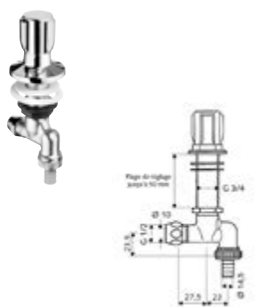
DIANA Spültischventil mit Rohrbelüfter mit Rückflussverhinderer, Belüfter und Schlauchverschraubung, Verstellbereich 1-50 mm, Dimension DN 15 x Ø 10 mm G 1/2 AG, verchromt, (DI407970500)
