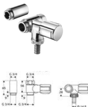
DIANA Nebenanschlussventil für Wandbatterie rechts mit Rückflussverhinderer und Schlauchverschraubung, Prüfzeichen PA-IX 2851/II, Dimension DN 20 G 3/4 AG x G 3/4 IG, verchromt, (DI407923500)
