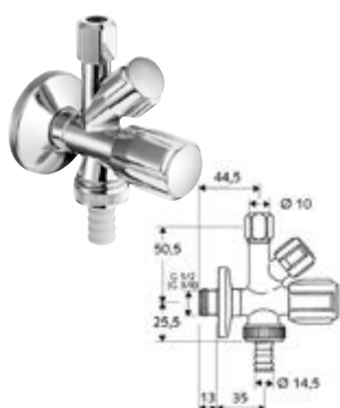
DIANA Kombi-Eckventil 1/2" mit ASAG mit selbstdichtendem Anschlussge- winde, mit Rückflussverhinderer und Schlauchverschraubung, Prüfzeichen PA-IX 2850/IA, Dimension DN 15 G 1/2 AG, erchromt, (DI407901500)
