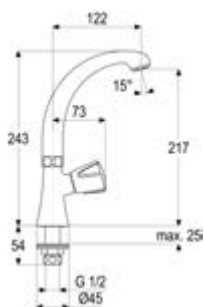
DIANA O100 Standventil Schwenkgussauslauf Ausladung 145 mm, G 1/2" kalt, verchromt, (DI407033500)
