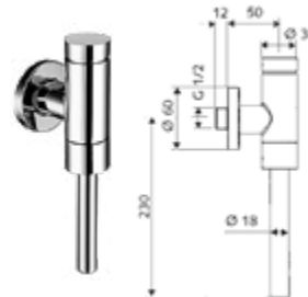
DIANA O100 Selbstschluss-Standventil für Kaltwasser, manuelle Auslösung, Durchfluss 5 l/min, Selbstschluss, voreingestellte Laufzeit ca. 7 s, Hochdruck, verchromt, (DI445032500)
