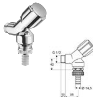
DIANA Geräteschrägsitzventil 1/2" mit RB ohne ASAG Sicherungskombination gem. EN1717 mit Rückflussverhinderer, Belüfter und Schlauchverschraubung, Prüfzeichen P-IX 007/1, DVGW zertifiziert, Dimension DN 15 G 1/2 AG, verchromt, (DI407910500) 68,20 €
