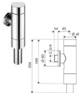
DIANA O100 WC-Druckspüler mit Drucktaste 3/4", mit Messing-Drucktaste für 1 Spülmenge, Spülmenge einstellbar 4,5 - 9 l, konform DIN EN 12541, verchromte Ganzmetallausführung, DN 20, (DI041113500) 198,- €
