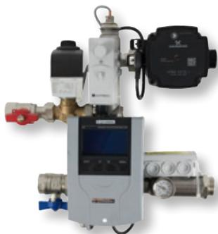
**ausreichend bis ca. 120 m<sup>2</sup> Fußbodenheizung**, witterungsgeführte Vorlauftemperaturregelung, inklusive Regelung mit Außen- und Vorlauftemperaturfühler, Beimischschaltung über 2-Wegeventil und 3-Punkt Stellmotor 230 V, Übertemperaturschutz durch STB, bei 60 °C und integriertes Rückschlagventil
