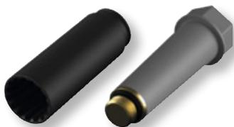
Wiederverwendbarer Spezialbaustopfen zur Montage der Dichthülse in der Rohbauphase, für die Dicht- und Belastungsprüfung mit Luft oder Wasser geeignet, mit einem metallischen Gewinde aus einem trinkwassergerechten Werkstoff, inklusive System Dichthülse
