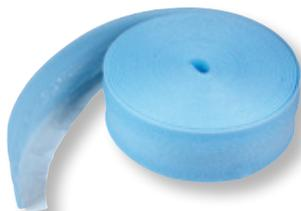
Für Zement- und Fließestriche bei Tackerplatten aus geschlossenzelligem Polyethylenschaum, mit seitlich angeschweißter Folienschürze und vorbereiteter Abreißschlitzung, nach DIN 18560.
