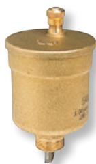
für thermische Solaranlagen, Gehäuse aus Pressmessing CW617N, Mechanik aus schlagzähem und temperaturfestem Kunststoff, beständig gegen Wasser, Wasser-Glykol-Gemische und neutrale nichtklebende Flüssigkeiten, in Verbindung mit Solar Absperrventil ist der Luftbrecher zu entfernen
