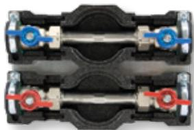
mit Wasserzählervorbereitung, passend für DITECH S und L Verteileranschlussstation, mit DVGW-Kugelhahn DN 20 vor und hinter dem Zählerdistanzstück, Flügelgriff für Trinkwasser warm in rot und Trinkwasser kalt in blau, Zählerdistanzstück 3/4" Länge 110 mm, montiert auf Montageblech mit Klick-System, zu schnellen Montage in DITECH Verteileranschlussstationen L und S, Anschluss 3/4" Innengewinde horizontal
