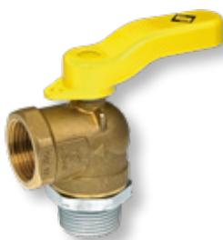
nach DIN EN 331 HTB-Ausführung 650 °C/30 min, eingangs Außengewinde, ausgangs Innengewinde, gesicherter Betätigungsgriff aus Aludruckguss, gelb lackiert, Gehäuse Pressmessing, Vollkugel Messing-verchromt, Kugeldichtung NBR, Schaltwellendichtung aus NBR, Betriebsdruck MOP 5/C1, HTB 1 bar, Umgebungstemperatur max. 60 °C, DIN-DVGW zertifiziert
