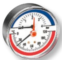
Kunststoffgehäuse, mit automatischem Absperrventil G1/2B, Druckanzeige in bar (blau), Temperaturanzeige 0–120 °C (rot), Sichtscheibe mit verstellbarem roten Markenzeiger, Genauigkeitsklasse: Thermometer 2,0 – Manometer 2,5
