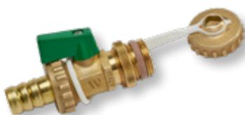
DVGW geprüft aus Messing CW617N-DW, 1/2", mit grünem Griff, Schlauchverschraubung, Anschluss 1/2" DN 15, max. Betriebsdruck 10 bar, max. Betriebstemperatur 150 °C, Mindesttemperatur -15° C, Keine Wärmeschockbeständigkeit. Funktionsfähigkeit: bei offenem oder geschlossenem Ventil, nicht teilweise offen oder geschlossen
