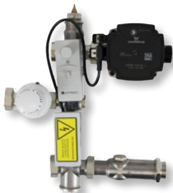
**ausreichend für ca. 120 m<sup>2</sup> Fußbodenheizung**, Festwertregelung einstellbar von 20–50 °C, Übertemperaturschutz durch STB, bei 60 °C und integriertes Rückschlagventil, Abmessung: Breite 278 x Höhe 336 x Tiefe 136 mm
