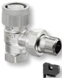
für den automatischen hydraulischen Abgleich, Einsatz in Zweirohr-Zentralheizungs- und Kühlanlagen mit Zwangsumwälzung. Druckunabhängiges Thermostatventil mit stufenloser Voreinstellung. Der Sollwert wird mit einem Voreinstellschlüssel durch Drehen des Handrades eingestellt. Einstellbereich von außen direkt ablesbar. Bei Ventilen mit „Q-Tech“ wird der Volumenstrom direkt eingestellt. Dieser wird auch bei schwankenden Differenzdrücken gehalten
