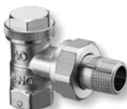
mit proportionaler Voreinstellung für den Einsatz in Warmwasser-Zentralheizungen und Kühlkreisläufen zum Absperrn, Füllen und Entleeren des Heizkörpers, Armatur aus Rotguss/Messing, Gehäuse vernickelt, Ventilkegel aus Messing mit EPDM O-Ringabdichtung, Messing-Schutzkappe mit zusätzlicher Weichdichtung, Einbaumaße nach DIN 3842 mit Anschluss für Gewindeverbindungen, maximale Betriebstemperatur: 120 °C, maximaler Betriebsdruck: 10 bar
