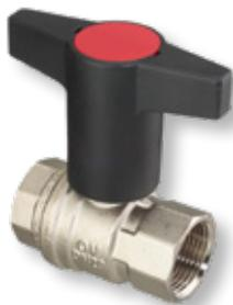
**Knebelgriff, Messing, Innengewinde, vernickelt, voller Durchgang, verlängerter Knebelgriff** aus Kunststoff (anthrazit) mit roter Abdeckkappe zur Strangkennzeichnung, Kugel Messing, verchromt, Dichtschalen aus PTFE, O-Ring-Abdichtung aus FK, Rohrleitungsarmatur für Flüssigkeiten, PN 20 für Kaltwasser, PN 16 für Medien von 0 – 100 °C, für Luft und andere ungefährliche Gase \*) PN 10, Betriebstemperatur: –10 °C – 100 °C, nicht Trinkwassergeeignet
