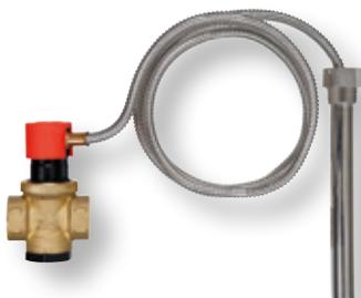
Mit zwei voneinander unabhängigen Fühlersystemen, zur thermischen Absicherung von geschlossenen oder offenen feststoffbefeuerten Heizungsanlagen nach DIN EN 12828 mit max. 86.000 kcal Heizleistung. Vorgeschieden auch bei Wechselbrandkesseln, die wahlweise auch mit festen Brennstoffen beheizt werden können. Bestehend aus: Ventilgehäuse aus Messing, Hubventil, 2 unabhängigen Faltenbalgweggebern mit flüssigkeitsgefülltem Temperaturfühler, Tauchhülse G 1/2
