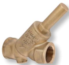
Gehäuse und Fettkammeroberteil aus Pressmessing nach DIN 50930-6; erfüllt die DIN-DVGW-Vorschriften und Schallschutzprüfungen bis DN 32; Dichtungen EPDM; mit Prüfschraube; Muffengewinde; Betriebstemperatur: maximal 90 °C; Betriebsdruck: max. 10 bar (PN 10); Öffnungsdruck: max. 0,2 bar
