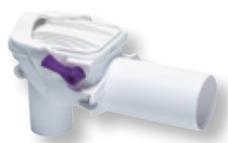
mit zwei selbsttätig schließenden Klappen, eine davon als handverriegelbarer Notverschluss, mit Wandbefestigung. Zulaufanschluss DN 40 senkrecht für bauseitigen Röhrengeruchverschluss, Ablauf DN 50 waagrecht zum Anschluss an HT-Rohr nach DIN 19560. Norm: DIN EN 13564 Typ 5. Einbaukörper: Kunststoff weiß.
