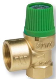
aus Pressmessing CW617N, Drehkappe aus hochwertigem, schlagzähem und temperaturfestem Kunststoff, Feder aus Stahl, Membrane und Dichtungen heißwasserbeständig, geeignet für Wasser, Wasser-Glykol-Gemische und neutrale nichtklebende Flüssigkeiten, maximale Betriebstemperatur 160 °C, Anschlüsse 1/2" x 3/4", bauteilgeprüft Kennbuchstabe SOL
