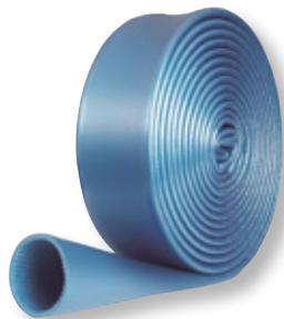
Rolle à 10 Meter, Preis/m, mit blauer, strapazierbarer Folienummantelung, zur Schalldämmung von Kunststoff-Abwasserrohren, normal entflammbar gemäß EN 13501-1, DSD = Dämmschichtdicke
