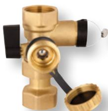
Kappenventil für Membran-AusdehnungsgefäÙe in Heizungsanlagen nach DIN EN 12828. Am Wassereingang des AusdehnungsgefäÙes einzubauen. Das Absperrventil ist mit Kappe und Plombe gegen unbeabsichtigtes SchlieÙen gesichert. Bei der vorgeschriebenen Funktionsprüfung oder bei Austausch kann das AusdehnungsgefäÙ gegen die Heizungsanlage abgesperrt und am KFE-Hahn entleert werden.
