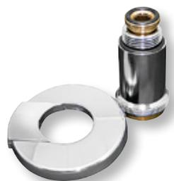
zur nachträglichen Montage auf bereits vorhandene Geradsitzventile nach DIN 3512, stufenlose Anpassung des Steigrohrkolbens bei Vormontage des Anschlusssets durch Gewindespindel, Armatur und Anschlussset glanzverchromt, inklusive 2-teiliger Wandabdeckrosette, verchromt
