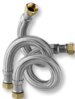
Flexible Panzerschläuche, Material Inliner PERT (Polyethylene of raised temperature), DVGW Trinkwasserzulassung, KTW-BWGL, extrem flexibel und knickfest für engste Einbausituationen geeignet, konstante Flussrate, flexibler korrigierter PERT Innenschlauch, Innen- und Außengewinde aus Messing, rostfreie Edelstahlflechtung AISI 304, Betriebsdruck 10 bar, Temperatur geprüft 90 °C, inklusive Faserdichtung
