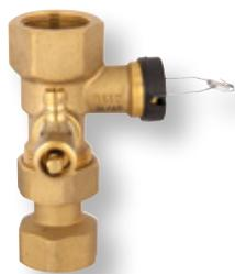
Kappenventil für Membran-AusdehnungsgefäÙe in Heizungsanlagen nach DIN EN 12828. Am Wassereingang des AusdehnungsgefäÙes einzubauen. Das Absperrventil ist mit Kappe und Plombe gegen unbeabsichtigtes SchlieÙen gesichert. Bei der vorgeschriebenen Funktionsprüfung oder bei Austausch kann das AusdehnungsgefäÙ gegen die Heizungsanlage abgesperrt und am Ablasshahn entleert werden.
