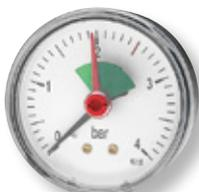
Druckmessgerät für geschlossene Heizungsanlagen, 0–4 bar, mit verstellbarem roten Markenzeiger mit grünem Sektor, rote Marke bei 2,5 bar und grünem Betriebssektor von 1,5–2,5 bar, Genauigkeitsklasse 2,5
