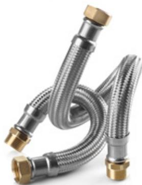
Flexible Panzerschläuche, Material Inliner PERT (Polyethylene of raised temperature), DVGW Trinkwasserzulassung, KTW-BWGL, extrem flexibel und knickfest für engste Einbausituationen geeignet, konstante Flussrate, flexibler korrigierter PERT Innenschlauch, Innen- und Außengewinde aus Messing, rostfreie Edelstahlflechtung AISI 304, Betriebsdruck 10 bar, Temperatur geprüft 90 °C, inklusive Faserdichtung
