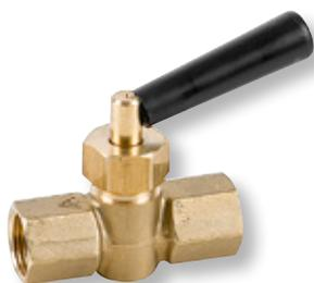
Dreiwegehahn aus Messing, mit Stopfbuchse, PN 25, Betriebstemperatur 10°C bis +50°C, Betriebsstellung ist auf dem Küken eingraviert, Handgriff aus Kunststoff, Anschluss: Muffe-Muffe
