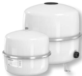
für geschlossene Heizungs- und Kühlanlagen gemäß EN12828, Zulassung gemäß EU Druckgeräterichtlinie 2014/18/EU, Stickstofffüllung für ein längeres Aufrechterhalten des Vordrucks, Membrane: Stülp-Membrane, geeignet für die Zugabe von bis zu 50 % Frostschutzmittel auf Glykolbasis, Gefäße konform EN13831, geeignet für Anlagen mit einer maximalen Durchflusstemperatur von 120°C, maximale Betriebstemperatur (an der Membran): 70°C. Gefäße 35–80 Liter mit angeschweißten Füßen zur Befestigung
