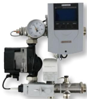
**ausreichend bis ca. 120 m<sup>2</sup> Fußbodenheizung**, witterungsgeführte Vorlauftemperaturregelung, inklusive Regelung mit Außen- und Vorlauftemperaturfühler, Beimischschaltung über 2-Wegeventil und 3-Punkt Stellmotor 230 V, Übertemperaturschutz durch STB, bei 60 °C, **integriertes Regulierventil (Kvs = 2,88 m<sup>3</sup>/h)** zur einfachen Einregulierung des Volumenstromes und integriertes Rückschlagventil
