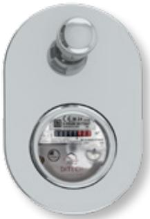
mit patentiertem „Hosenträger“-Dichtungssystem für zuverlässige Bypasskontrolle, mit selbstreinigender Messkammer und unbenetztem Gewinde, Chromgarnitur bestehend aus: einteiliger Rosette mit Zylinder, plombierbar, Ventilgriff chrom, Mediumtemperatur: max. 90 °C, Dauerdurchfluss Q3: 2,50 m<sup>3</sup>/h, metrologische Klasse: R 40 / R 40, Zähleranschlussgewinde: M60x2, Betriebsdruck: 10 bar, Einbau: horizontal / vertikal, Schnittstelle DM1, funkvorbereitet
