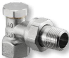
mit proportionaler Voreinstellung für den Einsatz in Warmwasser-Zentralheizungen und Kühlkreisläufen zum Absperrn, Armatur aus Messing, Gehäuse vernickelt, Ventilkegel aus Messing mit EPDM O-Ringabdichtung, Messing Schutzkappe mit zusätzlicher Weichdichtung, Einbaumaße nach DIN 3842 mit Anschluss für Gewindeverbindungen, maximale Betriebstemperatur: 120 °C maximaler Betriebsdruck: 10 bar
