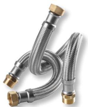
Flexible Panzerschläuche, Material Inliner PERT (Polyethylene of raised temperature), DVGW Trinkwasserzulassung, KTW-BWGL, extrem flexibel und knickfest für engste Einbausituationen geeignet, konstante Flussrate, flexibler korrigierter PERT Innenschlauch, Innen- und Außengewinde aus Messing, rostfreie Edelstahlflechtung AISI 304, Betriebsdruck 10 bar, Temperatur geprüft 90 °C, inklusive Faserdichtung
