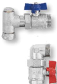
ohne Wärmezählervorbereitung passend für DITECH Verteileranschlussstationen L und S, mit Winkelanschlussstück 90° aus Edelstahl und Vor- und Rücklaufkugelhahn aus Messing vernickelt, Flügelgriff für Vorlauf in rot und Rücklauf in blau, Primäranschluss 3/4" oder 1" Innengewinde vertikal
