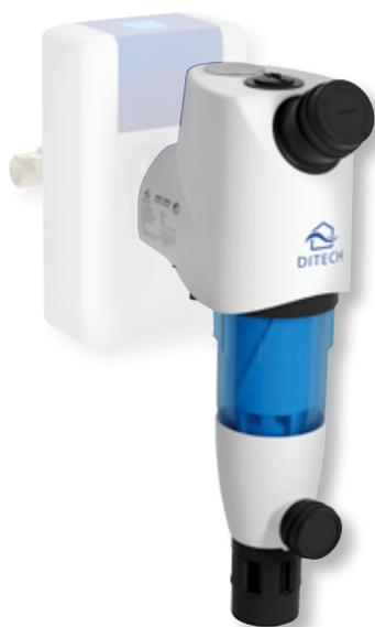
Rückspülfilter mit Druckminderer und Manometer, mit Wartungsanzeige und Wartungsabspernung, Verwendungsbereich: für Trinkwasser bis 30 °C, Betriebsdruck: mindestens 2 bar, maximal 16 bar, nachrüstbar mit Rückspülautomatik. **DITECH Universalflansch DT3631.. oder DT361325 muss separat bestellt werden. Passender Leckageschutz DT3637 siehe Seite 156.**
