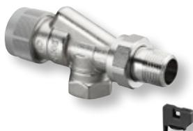
Einsatz in Zweirohr-Zentralheizungs- und Kühlanlagen mit Zwangsumwälzung. Druckunabhängiges Thermostatventil mit stufenloser Voreinstellung. Der Sollwert wird mit einem Voreinstellschlüssel durch Drehen des Handrades eingestellt. Einstellbereich von außen direkt ablesbar. Bei Ventilen mit „Q-Tech“ wird der Volumenstrom direkt eingestellt. Dieser wird auch bei schwankenden Differenzdrücken gehalten
