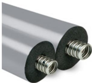
vorisoliertes und UV-beständiges Dämmsystem mit zwei Edelstahlwellrohren zum einfachen und fachgerechten Anschluss von Wärmepumpenaußeneinheiten. Passend dazu Übergangsverschraubungen zum Verbinden der Leitungen mit den Anschlüssen der Außen- mit der Inneneinheit im Set enthalten. UV-beständige und robuste Außenhaut der Dämmung, Farbe der Außenhaut grau. Dämmung Elastomerschaum gemäß 14304, mit Polyolefin-Copolymer Beschichtung.
