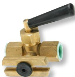
Manometerhahn mit Prüfflansch 60x25, Dreiwegehahn, aus Messing, mit Stopfbuchse, PN 25, Betriebstemperatur 10°C bis +50°C, Betriebsstellung ist auf dem Küken eingraviert, Handgriff aus Kunststoff, Anschluss: Muffe-Muffe
