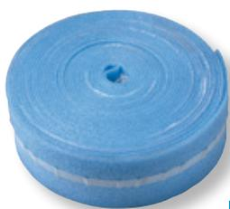
Für Zement- und Fließestriche und alle Systemplatten aus geschlossenzelligem Polyethylenschaum, mit seitlich angeschweißter extrabreiter Folienschürze und vorbereiteter Abreißschlitzung, nach DIN 18560, selbstklebend.
