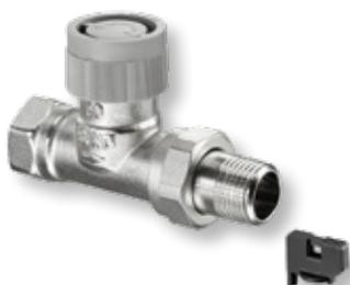
für den automatischen hydraulischen Abgleich, Einsatz in Zweirohr-Zentralheizungs- und Kühlanlagen mit Zwangsumwälzung. Druckunabhängiges Thermostatventil mit stufenloser Voreinstellung. Der Sollwert wird mit einem Voreinstellschlüssel durch Drehen des Handrades eingestellt. Einstellbereich von außen direkt ablesbar. Bei Ventilen mit „Q-Tech“ wird der Volumenstrom direkt eingestellt. Dieser wird auch bei schwankenden Differenzdrücken gehalten
